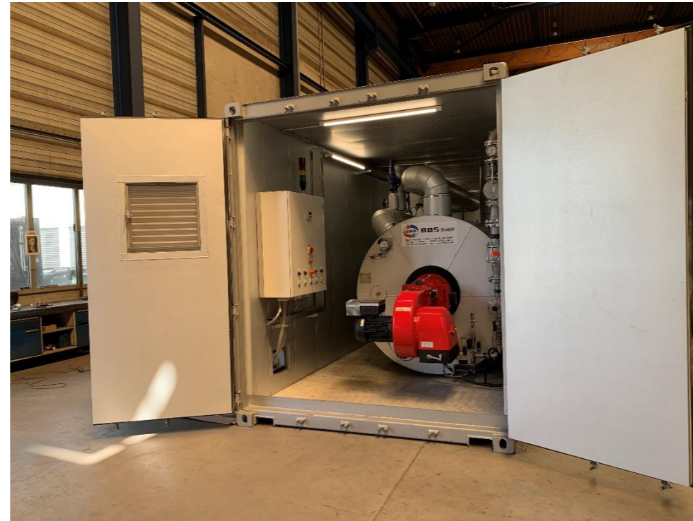
BBS-Containeranlage mit einem Thermalölkessel 1.800 kW.
